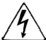
Предупреждает пользователя о наличии незащищенных “опасных” токопроводящих поверхностей и возможности поражения электрическим током.
