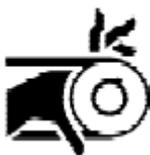
Данный символ указывает на внутренние механические части, которые могут быть опасными для пользователя. Защитные корпуса должны быть установлены на своих местах во время работы.
